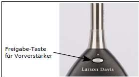
Abbildung 2.4: Freigabe-Taste beim Entfernen des Vorverstärkers
